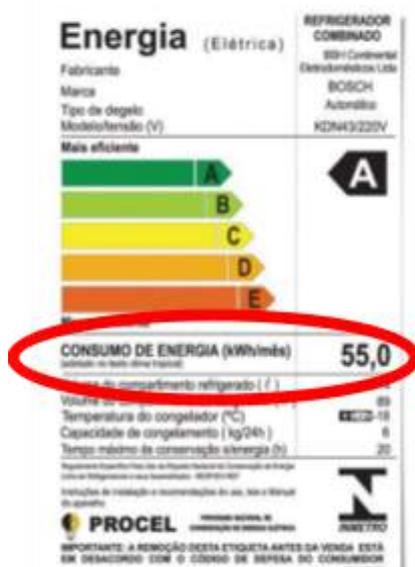
Adesivo fixado pelo fabricante de produto eletrodoméstico, indicando o consumo de energia elétrica em KWh, como destacado em vermelho.
